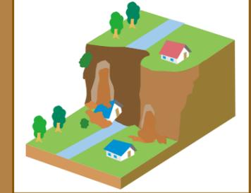
「がけ崩れ」は、地中にしみ込んだ水分が土の抵抗力を弱め、雨や地震等の影響によって急激に斜面が崩れ落ちることをいいます。
