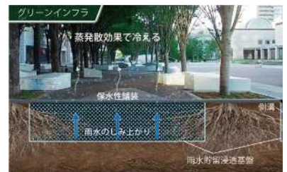
グリーンインフラ 蒸発散効果で冷える 保水性舗装 雨水のしみ上がり 雨水貯留浸透基盤 雨水貯留浸透基盤材と保水性舗装を活用した蒸発散効果の概念図 東邦レオ株式会社 https://greeninfrastructure.jp/case/yokohama_park/
