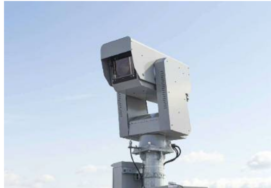
高所監視カメラ
