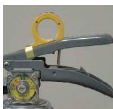
× レバー支えの脱落
