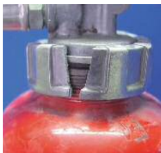
× キャップの破損
