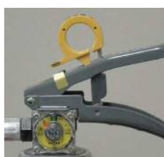
× 安全栓の抜けかけ
