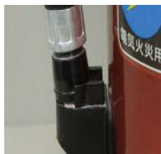
× 消火薬剤の漏れ
