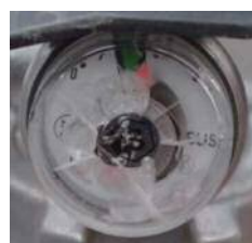
× 指示圧力計の損傷
