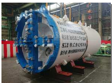
トンネルを掘るための シールドマシン
