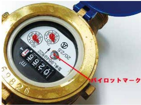
家の中で漏水が起きていないかどうか、簡単に確認する方法があります。家中の蛇口を全て閉めてから、水道メーターのパイロットマーク（写真参照）を確認してください。わず
