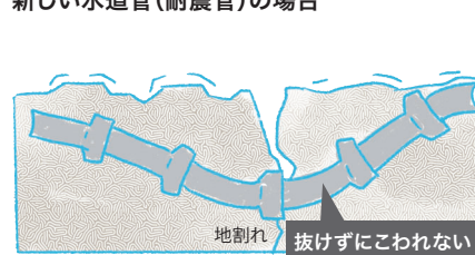
新しい水道管（耐震管）の場合
