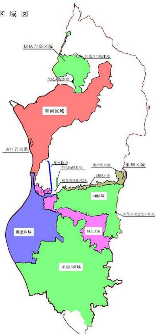
池田市の下水道事業の普及・施設状況を示します。平成21年度に地方公営企業法の全部適用を行っています。本市処理区域のうち、箕面川以南の石橋、旭丘、新町の一部と細河地区は猪名川流域下水道に接続しています。池田市下水道処理場で処理を行う池田処理区においては、当初、合流式下水道として整備を行いましたが、雨水管渠の整備や合流改善により分流化を進めています。
