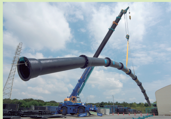
メーカーによる耐震管の吊り上げ実験
